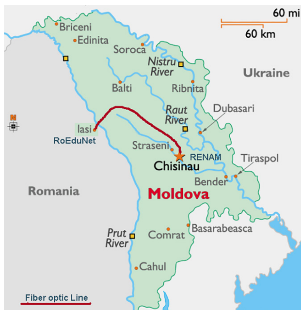
Figura 4. Canalul optic de interconectare RENAM – RoEduNet, mai 2010
