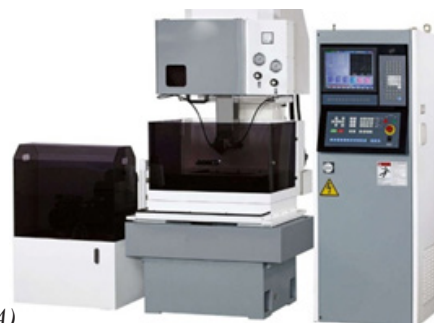
Figura 3. Utilaje de prelucrare a metalelor prin electroeroziune (metoda B. Lazarenco), fabricate la scară mondială
