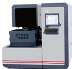
Figura 3. Utilaje de prelucrare a metalelor prin electroeroziune (metoda B. Lazarenco), fabricate la scară mondială
