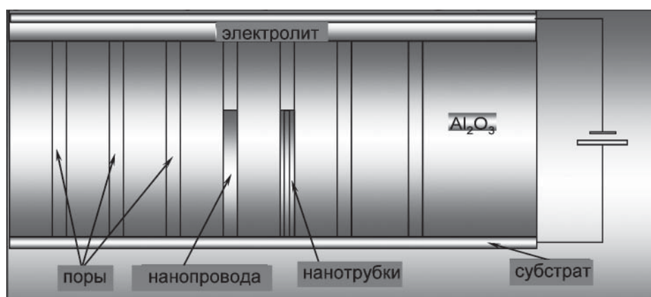
Рис. 1. Схема осуществления электрохимического темплатного синтеза
