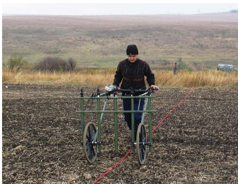
Figura 1. Magnetometru cu cinci sonde în timpul măsurătorilor de la Sobari, raionul Soroca
