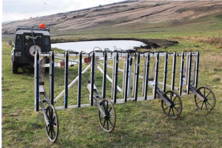
Figura 4. Magnetometru cu 16 sonde în timpul măsurărilor în situl de la Sângerei
